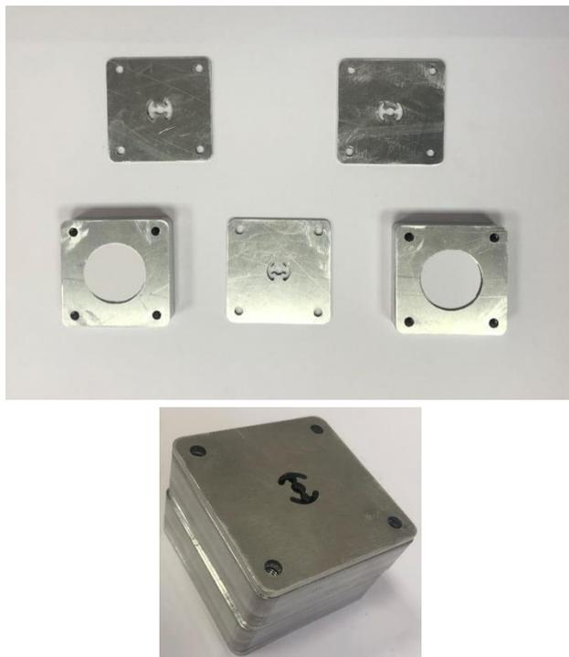
Рис. 6. Изготовленный прототип полосно-пропускающего фильтра третьего порядка.
