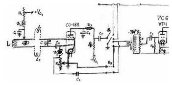
Fig. 5. Schematic diagram of Zavoisky's autodyne experimental bench. Рис. 5. Принципиальная схема автодинной части экспериментального стенда Е. К. Завойского
