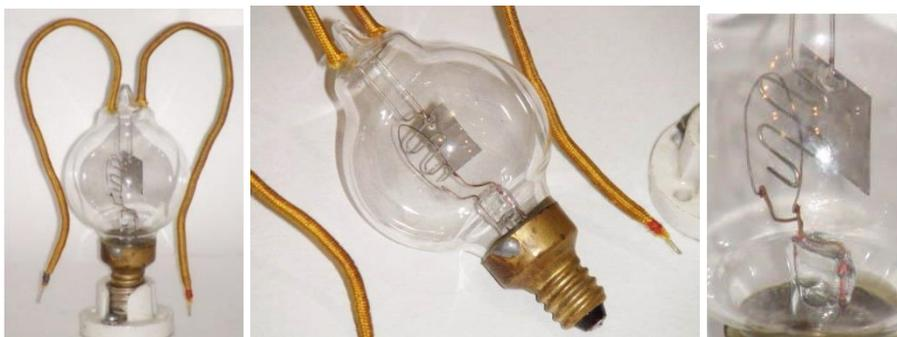
Рис. 2. Аудион сферической формы с одной нитью накала. 1908 г.
