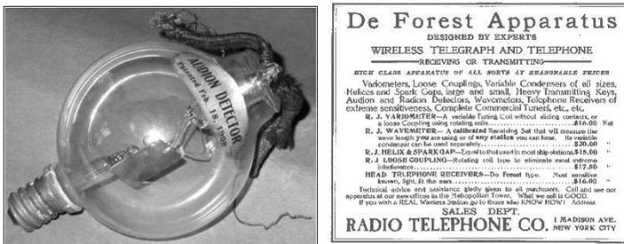
Рис. 6. Первая коммерческая трехэлектродная вакуумная лампа *Audion* и ее реклама в журнале «*Modern-Electrics*» 1909 г. [8]
